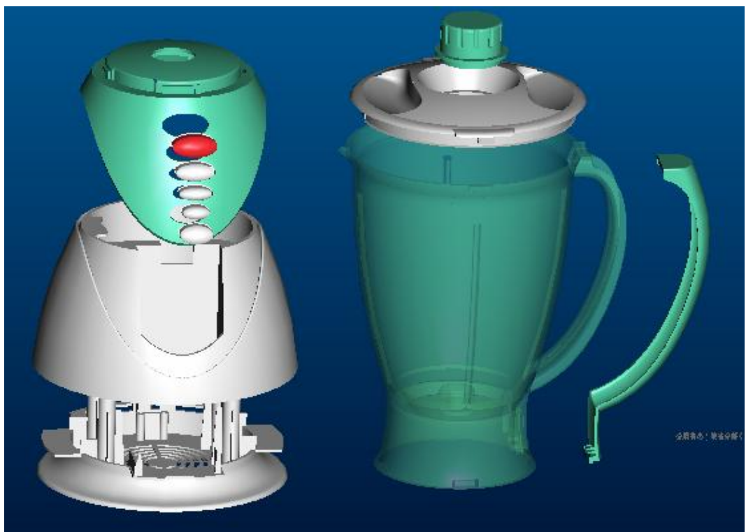
图 2.20 榨汁机分解图
